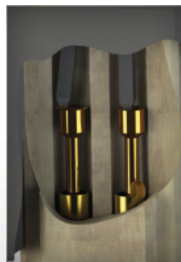
Abrieb / Schmutz = Standzeit Federkontaktstifte massiv reduziert = Form / Toleranz des Steckers n.i.O
