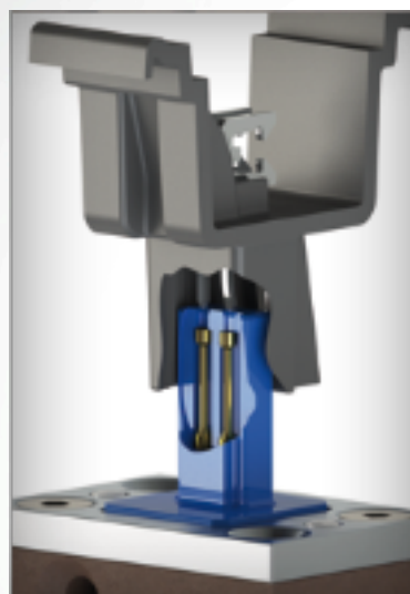
Kontaktpin außerhalb des Taumelkreises = n.i.O
